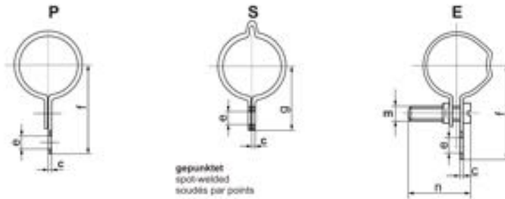
Schellen P unterzementiert und lötfähig Tabs P with cement underlay and solderable Colliers P sous ciment et soudable
